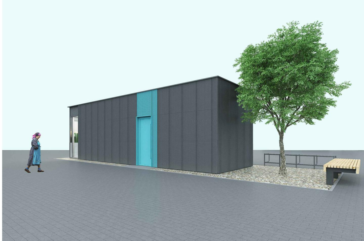
ФАСАДНЫЕ ПАНЕЛИ МЕТАЛЛИЧЕСКИЕ ИЗ ПРОСЕЧНО-ВЫТЯЖНОЙ СЕТКИ (ПВС), цвет RAL 7024, RAL 6027 (см. лист с примерами)
